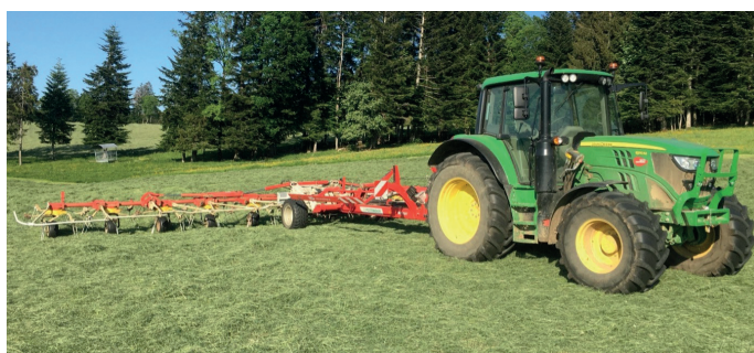
Un premier fanage énergique pour répartir le fourrage, puis un régime prise de force plus faible pour ensuite retourner le foin.
